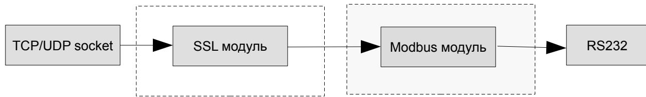
Рис 3.1 Функциональная схема включения модулей.
